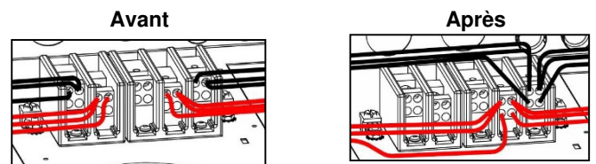
Figure 4 : Conversion de deux fils à un fil
